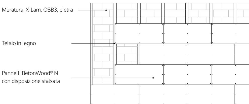
Il sistema include la fornitura di accessori, profili di partenza, angolari, viti autoperforanti. Collante rasante raccomandato e rivestimento.
