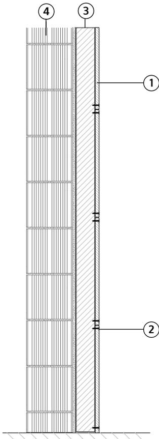
1. **Cementolegno BetonWood® N** spessore 22 mm - È un pannello in cementolegno ad alta densità (1350 kg/m<sup>3</sup>) ed elevata resistenza a compressione (oltre 9000 kPa). Adatto per essere impiegato in tutti i luoghi pubblici dove ci sia necessità di un materiale duro, resistente, certificato al fuoco in classe A2. Materiale certificato FSC® e PEFC™. Pannello con bordi a spigolo vivo. Dimensioni 1220 x 520 mm.
