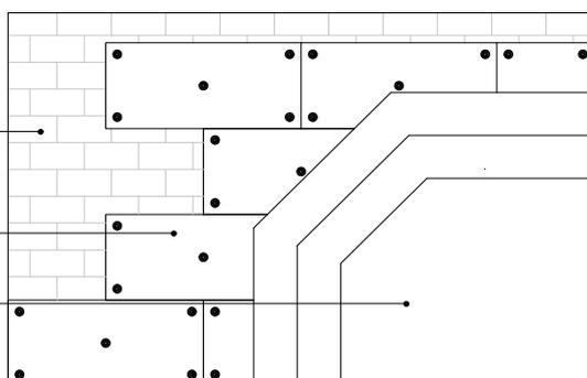
Il cappotto termico in sughero biondo **Cork Panels L 180** è completamente naturale e può essere installato su muratura, X-Lam, strutture in legno, OSB3, calcestruzzo e pietra.
